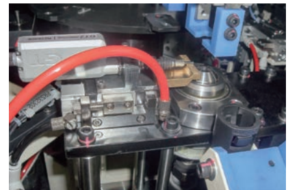
振れ検査部 (接触式)
